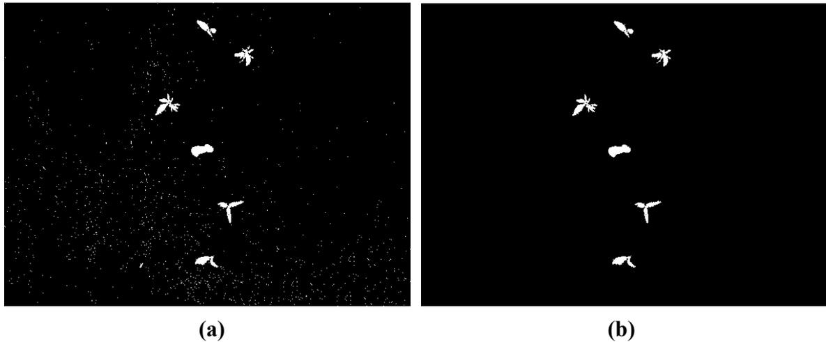
图 3-7 面积滤波去噪处理 (a) 二值图像 (b) 面积滤波图像
