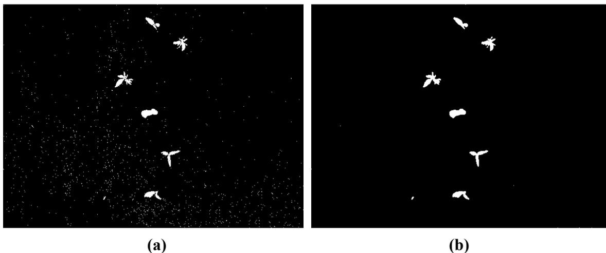
图 3-6 中值滤波去噪处理 (a) 二值图像 (b) 中值滤波图像
